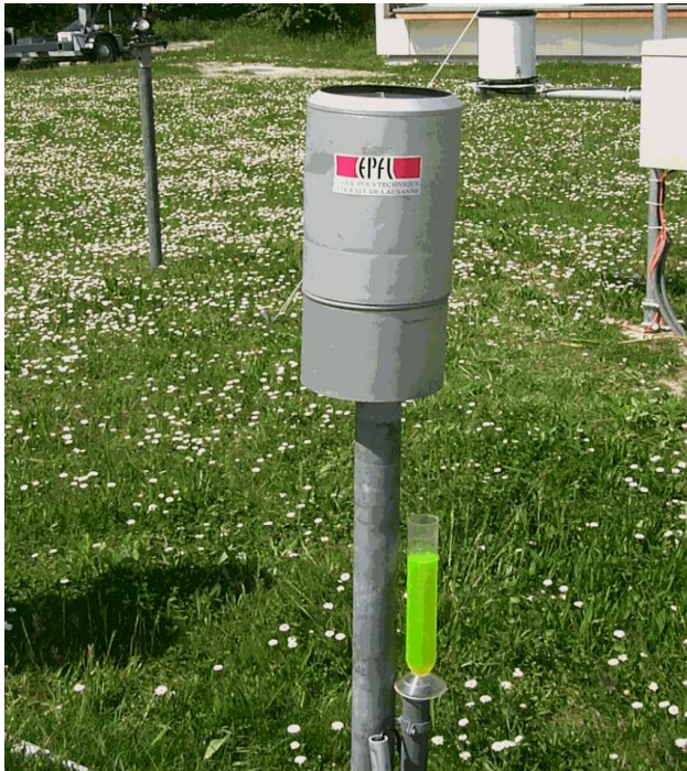
Pluviomètre Hellmann (Suisse) D = 200 \text{ cm}^2
