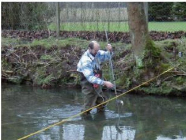
Jaugeage à l'aide d'un moulinet (photo Diren Haute Normandie)
