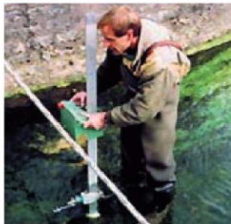
Jaugeage à l'aide d'un profileur (phot Diren Bourgogne)
