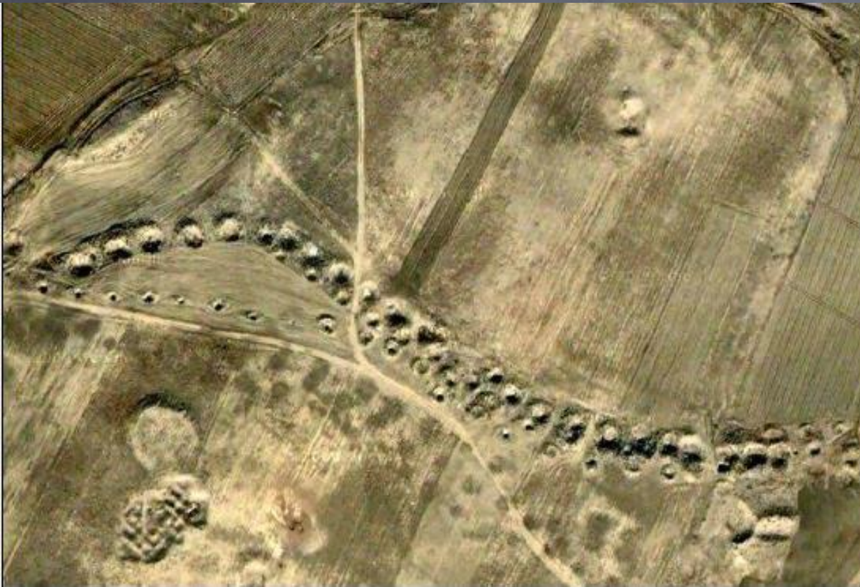
Quanât (Iran) : puits et galeries
